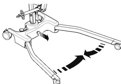
3. Afloje el dispositivo de bloqueo del mástil (2 - no completamente), levante el conjunto del mástil y del larguero (3) y pliegue con cuidado hacia las patas. Utilice el asa de empuje para ayudar en este movimiento.
