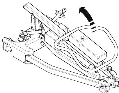
4. Levante el conjunto de piezas del mástil en posición vertical (utilizando la parte superior de la empuñadura) y coloque el mástil en la ranura, alineando las etiquetas de ensamble del mástil (1). Ajuste los pomos de fijación del mástil (2) y destrabe las rueditas (3).
