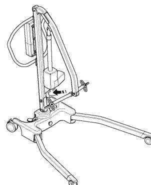
2. Libere el dispositivo de bloqueo de la pata (tirando hacia fuera desde la base de fundición), cierre las patas juntas.
