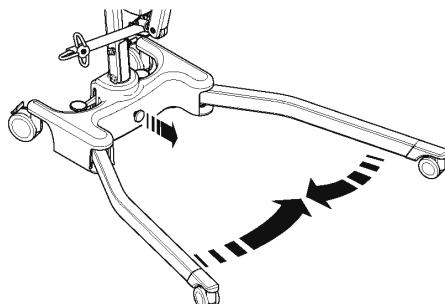
**3.** Lösen Sie die Mast-Feststellknöpfe (2 - nicht vollständig herausdrehen), heben Sie die Mast/Ausleger-Baugruppe an (3), und legen Sie diese vorsichtig auf dem Fahrgestell ab. Verwenden Sie dabei den Schiebehandgriff.
