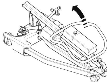
4. Heben Sie den kompletten Mast aufrecht an (mit der Oberseite des Schiebegriffs) und senken Sie den Mast so in die Aussparung ab, dass die Schilder mit den Einrastmarkierungen des Masts (1) ausgerichtet sind, ziehen Sie die Einrastknöpfe für den Mast (2) fest und lösen Sie die Bremse an den Lenkrädern (3).
