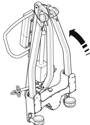
5. D'un coup sec, tirez la sangle de retenue vers le haut et étendez-la au-dessus des roues. (Cela empêche les pieds, le mât et la flèche de se séparer durant le transport et l'entreposage).
