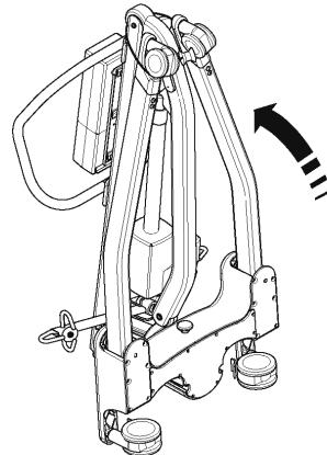
5. Tire de la correa de retención hacia arriba y extiéndala sobre las ruedas. (Esto mantendrá las patas, el mástil y el larguero juntos durante el transporte y almacenamiento).
