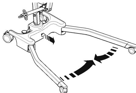
3. Desserrez le dispositif de verrouillage du mât (2) (pas entièrement), soulevez le mât et la flèche (3) et repliez-les soigneusement vers les pieds. Utilisez la poignée de manœuvre pour faciliter ce mouvement.
