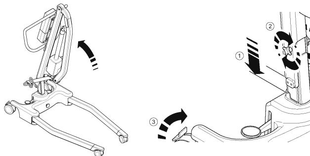
5. Spreizen Sie die Träger des Fahrgestells vollständig auf. VERGEWISSEN SIE SICH, dass der Fahrgestell-Feststellknopf bündig in der Fahrgestellbasis eingerastet ist und dass die Träger nicht mehr frei beweglich sind. Die Träger lassen sich dann nur noch mit dem Fußpedal auf der Rückseite der Basis verstellen.
