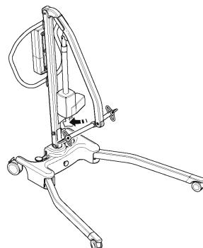
2. Lösen Sie die Fahrgestellsicherung (aus der Fahrgestellbasis ziehen) und führen Sie die Fahrgestellträger eng zusammen.
