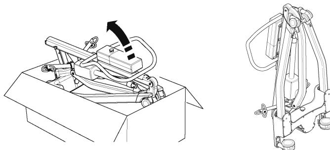
2. Suelte la pata y el conjunto del mástil aflojando la correa de retención de las ruedas. Esta correa se retrae completamente en la parte superior de la sección del mástil.
