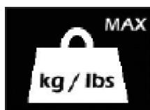
Si le lève-personne s'arrête en raison d'une surcharge (la charge à lever est supérieure à la charge maximale autorisée), le symbole de surcharge s'affiche sur l'écran LCD et le fonctionnement du lève-personne est interrompu jusqu'à ce que l'excès de charge ait été supprimé.
