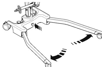
6. Lösen Sie den Spreizbügel aus dem Spreizbügelhalter. Der Lifter ist jetzt betriebsbereit.
