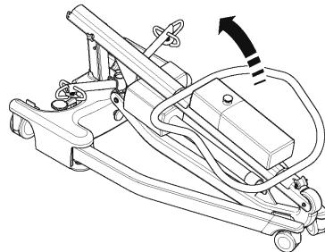
4. En l'attrapant par le haut de la poignée, redressez le mât en position verticale de sorte à l'insérer dans la fente, en alignant les autocollants (1). Serrez les molettes de verrouillage du mât (2) et déverrouillez les roulettes (3).
