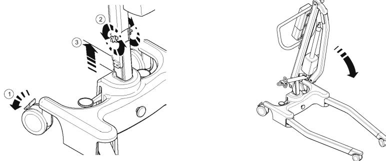
**4.** Stellen Sie den zusammengeklappten Advance hochkant (mit Fahrgestellträgern und Schiebehandgriff führen), und achten Sie darauf, dass Mast und Ausleger beim Hochstellen zusammen bleiben.
