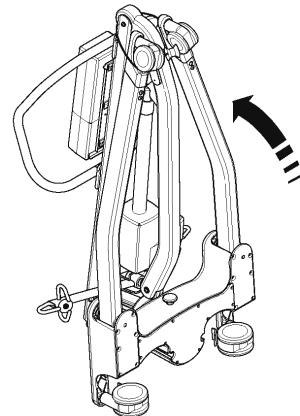
5. Ziehen Sie den Halteriemen steil nach oben, und legen Sie ihn über die Laufrollen. (Mit dem Riemen werden Fahrgestell, Mast und Ausleger für Transport und Lagerung arriert).
