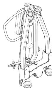
2. Lösen Sie Fahrgestell und Mast-Baugruppe, indem Sie den Halteriemen von den Rädern entfernen. Der Riemen wird im oberen Bereich des Mastes eingezogen.
