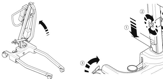
5. Écartez les pieds au maximum. ASSUREZ-VOUS que le bouton de verrouillage des pieds s'engage au ras de la base moulée et que les pieds sont immobilisés. Les pieds ne fonctionneront alors qu'au moyen du mécanisme à pédale situé à l'arrière de la base.
