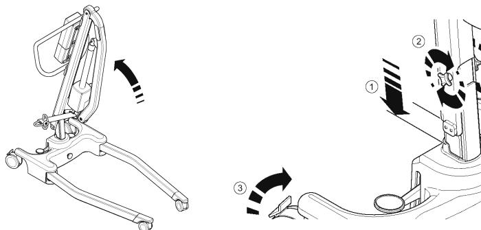
5. Abra las patas completamente. ASEGÚRESE de que el botón de bloqueo de la pata se inserta alineadamente contra la base de fundición y que las patas no se mueven ya libremente. Las patas solamente funcionarán mediante el uso del mecanismo de pedal situado en la parte posterior de la base.
