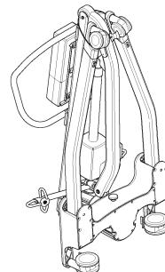
2. Dégagez le pied et le mât en détachant la sangle de retenue des roues. Cette sangle rentrera dans le haut de la section du mât.
